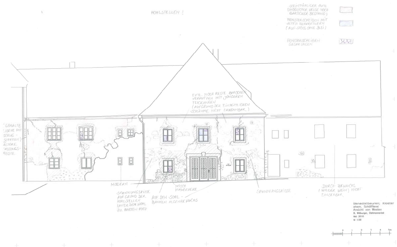
Abb. 52: Ansicht Westseite, Putzkartierung Mai 2010
